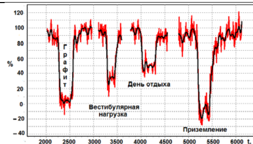
Рис.2 - Экспериментальная запись абсорбции гамма-квантов в голове космонавта (относительно графита).
